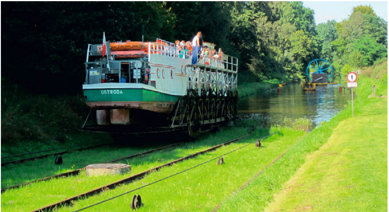
Oberlandkanal: Ein Schiff wird auf einer Lore über einen Rollberg gezogen (Foto: Joachim Scheuring)
