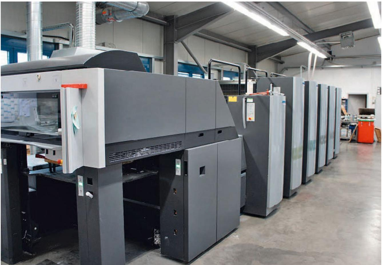
Die Dimensionen dieser hochmodernen Druckmaschine sind beachtlich: Höhe ca. 2 Meter, Breite ca. 2,5 m und die Länge ca. 8 m. Sobald alle Daten eingegeben sind, findet das Drucken nahezu automatisch statt, ebenso der Einzug der Papierbögen. Die Geschwindigkeit ist atemberaubend: **15.000 Bögen pro Stunde**. Um dem geschätzten Leser das Kopfrechnen zu ersparen, habe ich diese Anzahl auf Minuten und Sekunden heruntergebrochen:
